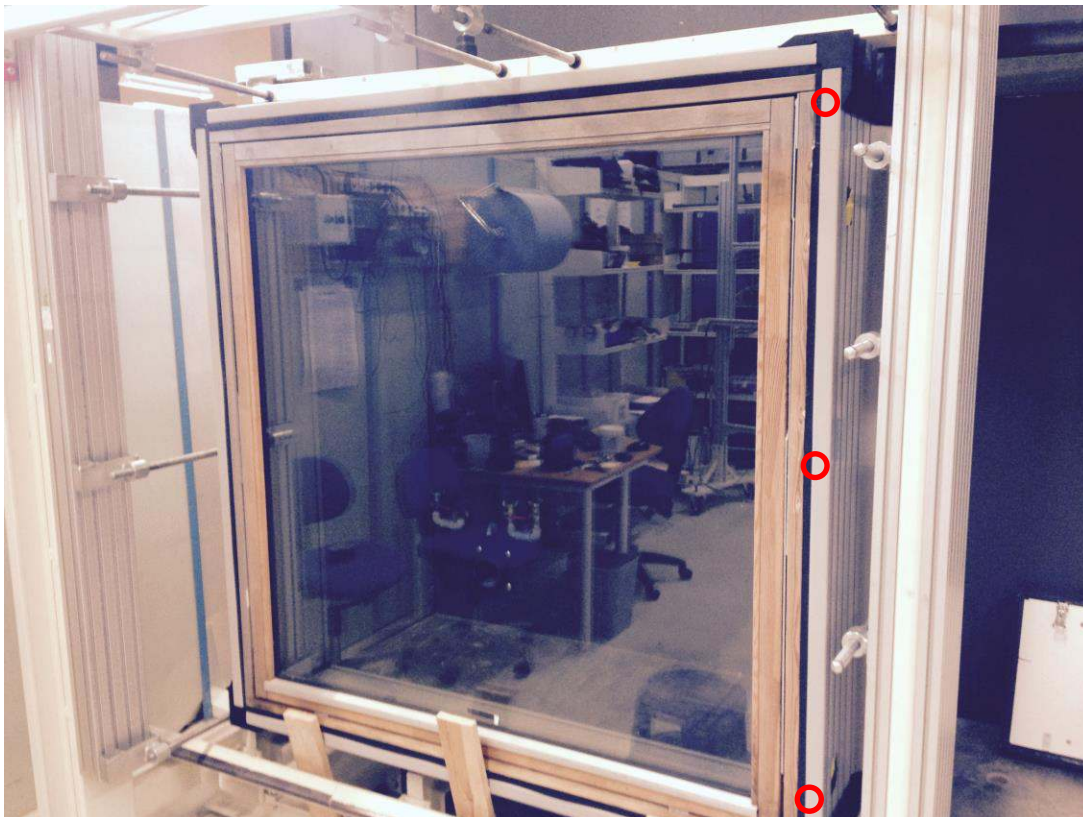
De røde cirkler indikerer punkterne, hvor deformationerne er målt.
